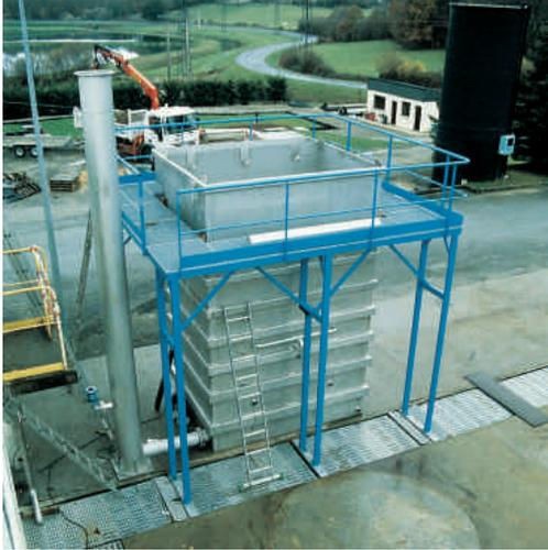
Le nouveau pilote Pulsator-Degrémont pour l'entraînement à l'exploitation des décanteurs à voile de boue
